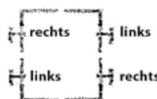
Die Bezeichnung "links" wird für Winkelbänder unten links und oben rechts verwendet.
